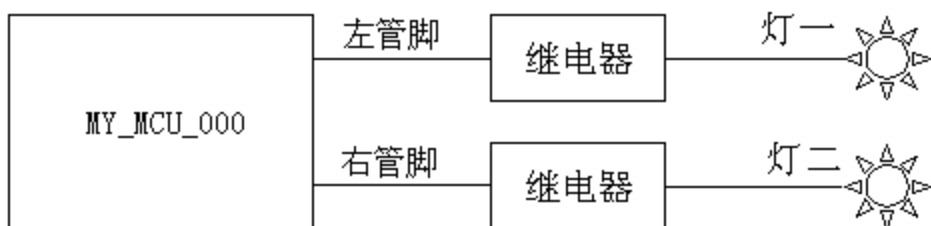
图 1.2.-2 MY_MCU_000 应用系统示意图
