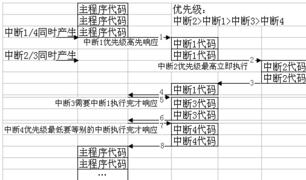
图 1.10.-12 中断嵌套示意图
